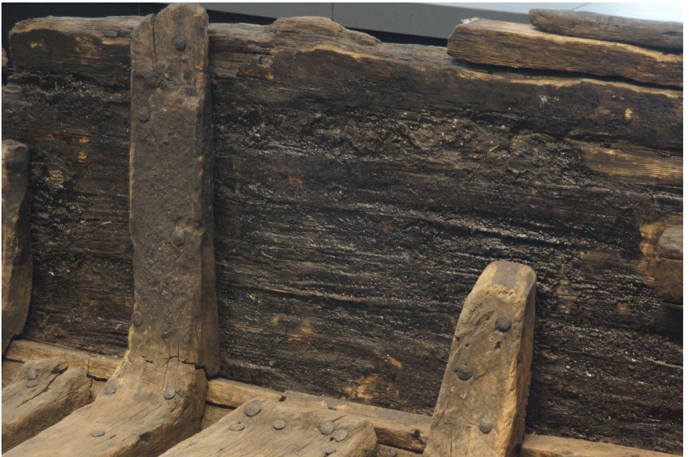
Les flancs et les traces du calfatage ainsi que les clous (environ 1700)
